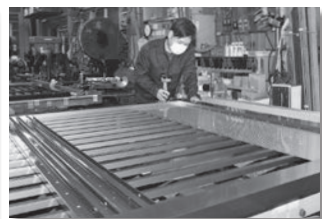
扉を組み立てる作業
